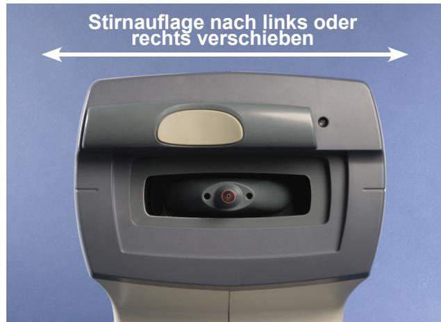
Das Reichert 7CR verfügt über eine nach links und rechts verschiebbare Stirnauflage, mit deren Hilfe das Gerät automatisch erkennen kann, welches Auge gemessen wird. Diese muss vollständig auf einer der beiden Seiten oder auf der anderen positioniert werden, um eine Messung vorzunehmen. Bringen Sie die Stirnauflage vor Messbeginn in die gewünschte Stellung.
